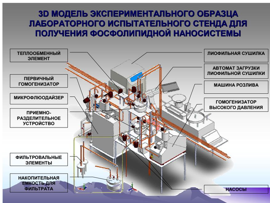
**Рис. 11.** Макет экспериментальной установки для получения НАНОФОСФОЛИПА.
