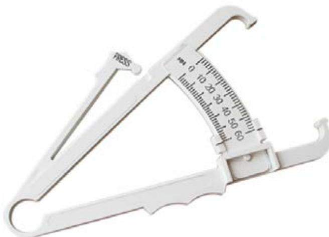
Рисунок 1. Прибор для измерения толщины подкожно-жировой клетчатки.
