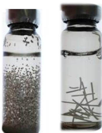
Рис. 25. Сферы PVA и цилиндры гидрогеля.
