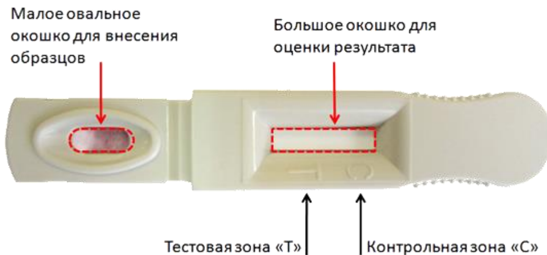
Рисунок 2.4 – Устройство тест-кассеты «КАРД-ИНФО»
