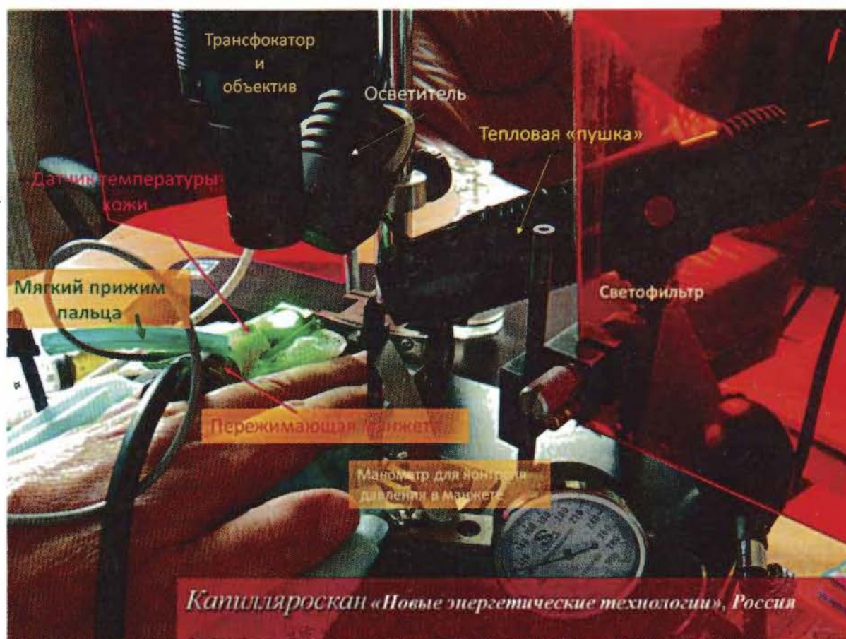
Рис. 16. Устройство компьютерного капилляроскопа
