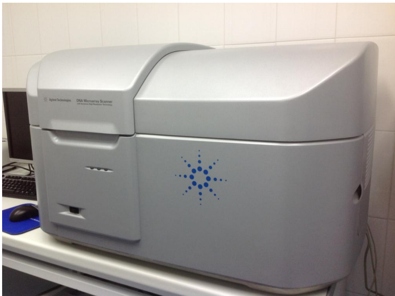
Рисунок 1. Прибор для проведения aCGH Agilent SureScan Microarray Scanner.
