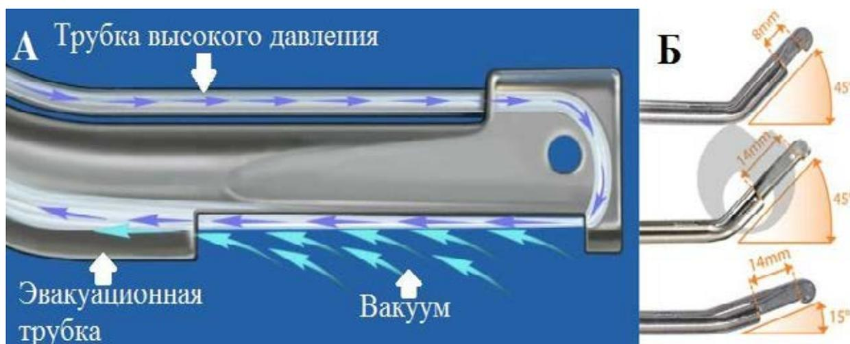
Рис. 7: А – эффект Вентури. Б – варианты изгиба рабочей поверхности ручки манипулятора (объяснение в тексте).
