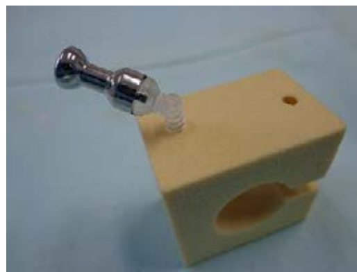
Рис. 4.10. Разрушение биodeградируемого винта при приложении избыточного усилия в ходе закручивания.
