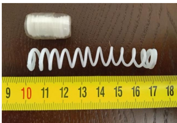
Рисунок 4. Пружина из биodeградируемого полимера поли-ε-капролактона в расправленном и сжатом виде (помещенная в желатиновую капсулу).
