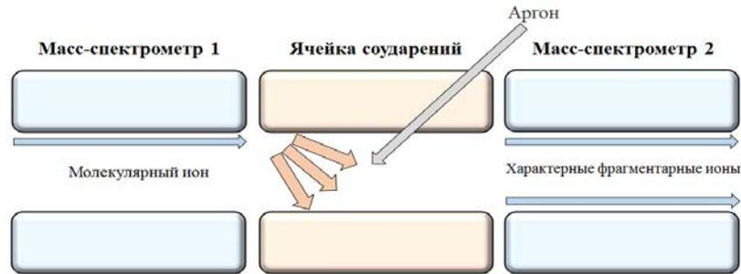
Рисунок 2 – Схема работы тандемного масс-спектрометра.
