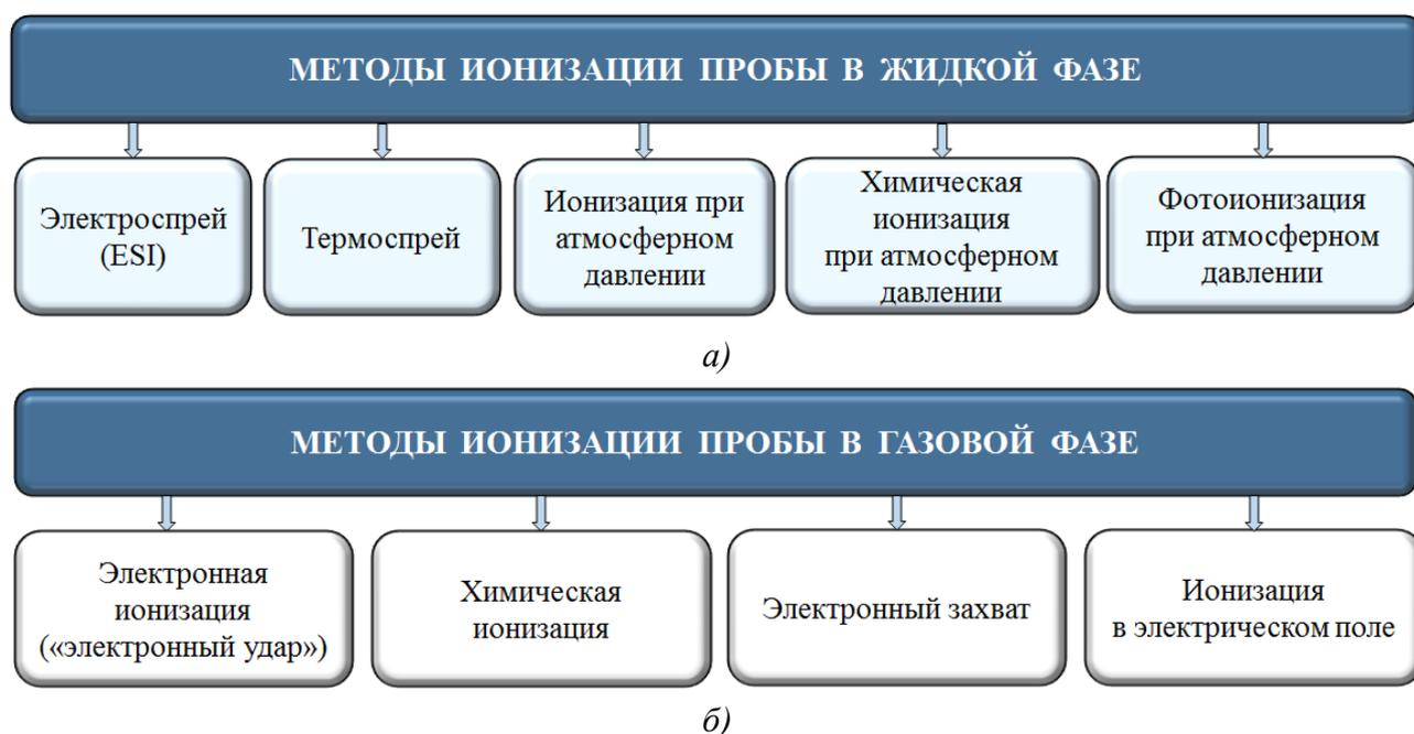
Рисунок 1 – Методы ионизации пробы в жидкой (а) и газовой (б) фазах в хромато-масс-спектрометрии.
