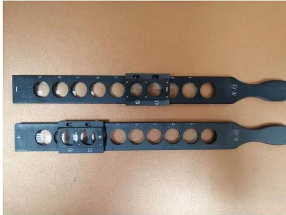
Рисунок 11 – Скиаскопические линейки ЛС-02
