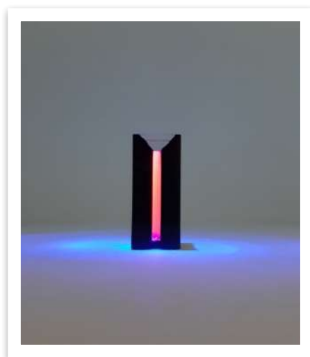
Рисунок 10 – Трехблочечная КТ InP/ZnSe/ZnS 650 МРА в кувезе для спектрофотометрии в ультрафиолетовой области (продемонстрирован эффект флуоресценции в ультрафиолетовой области)
