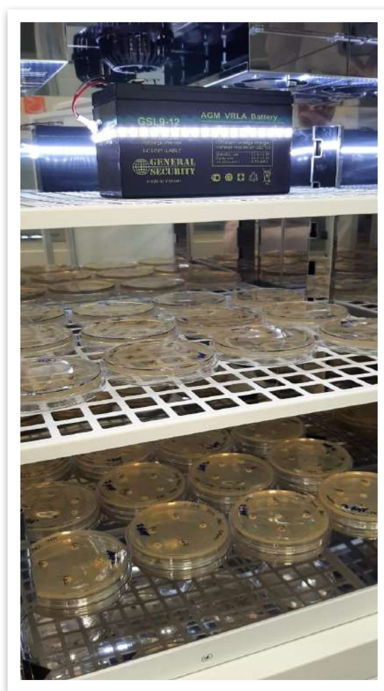
Рисунок 60 – Фаза инкубации в термостате в условиях фотовозбуждения КТ
