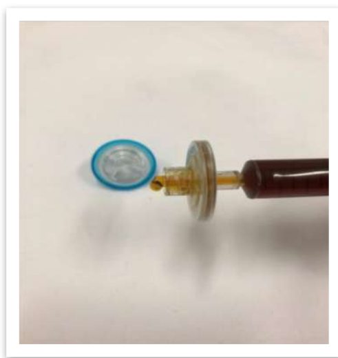
Рисунок 56 – Процесс пропускания нестерильного раствора КТ Ag(10%):InP/ZnS МРА через трековую мембрану под давлением
