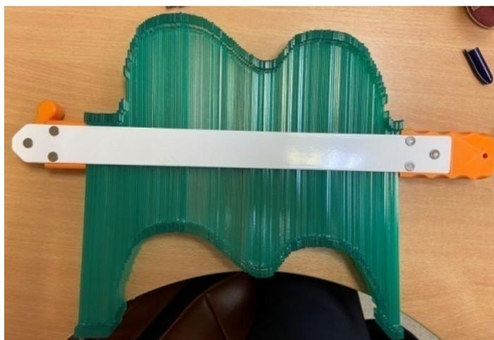
Рис. 13. Механический 3D-сканер
