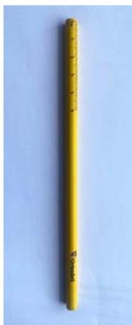
Рис. 12. Шкала для измерения глубины деформации
