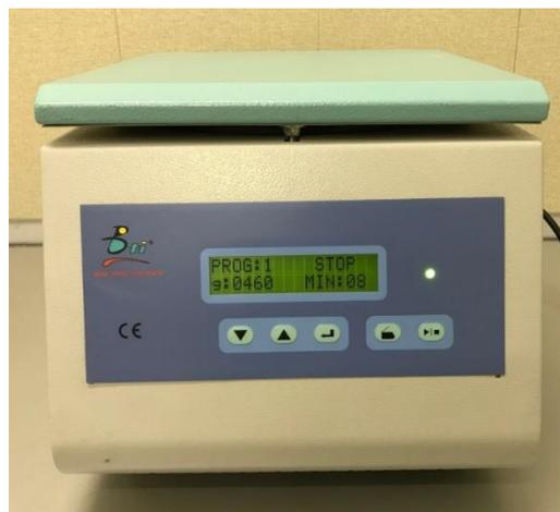
Рисунок 2.1 – Центрифуга ВТИ PRFG Sistema IV для получения плазмы крови, богатой факторами роста, по технологии PRGF-ENDORET
