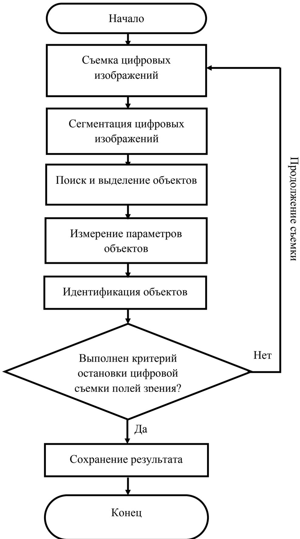
Рисунок 59 – Схема программной части автоматизированной системы бактериоскопической диагностики туберкулеза
