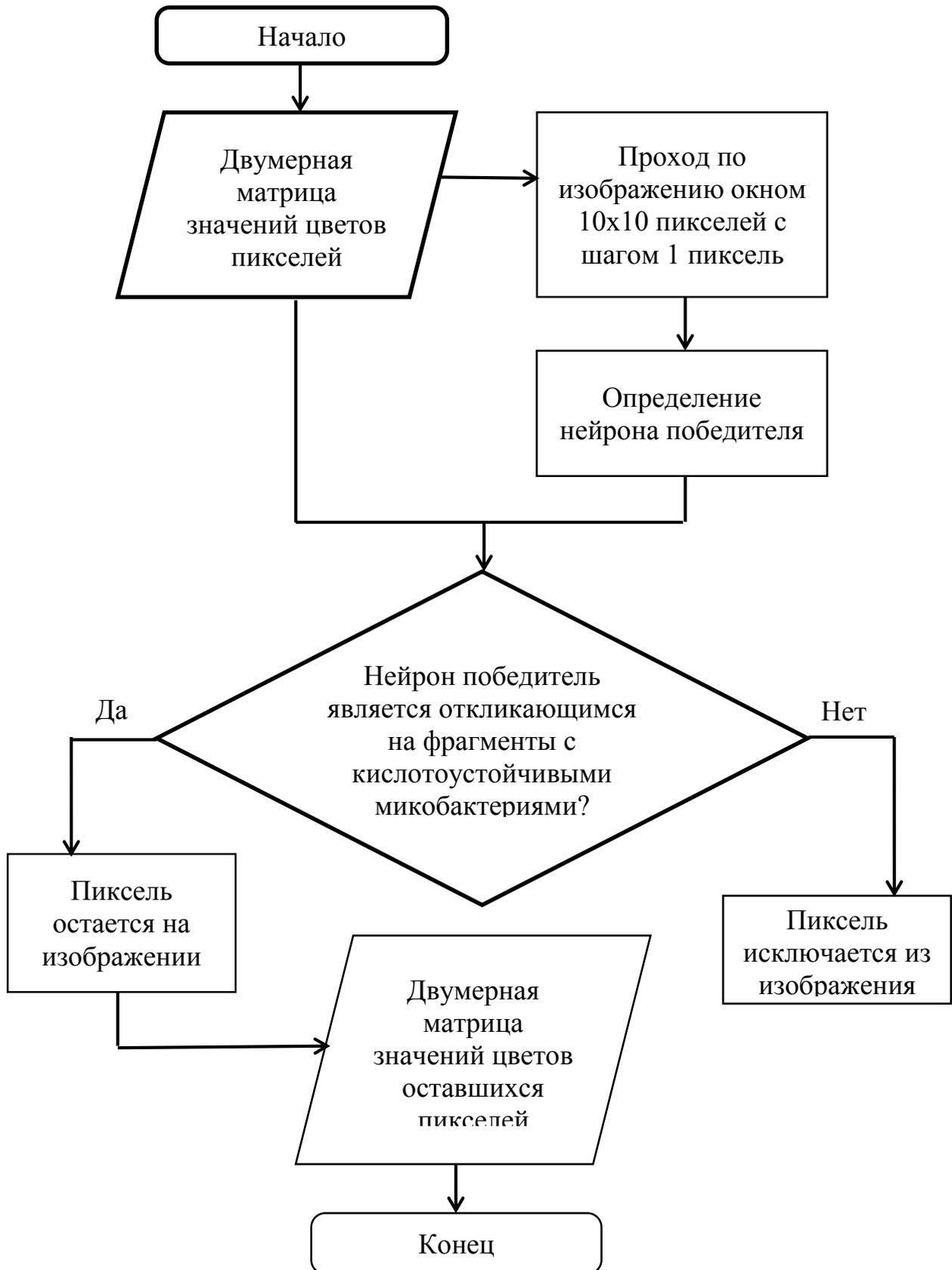
Рисунок 30 – Схема алгоритма сегментации микроскопического изображения мокроты, окрашенной по методу Циля-Нильсена с использованием самоорганизующейся карты Кохонена
