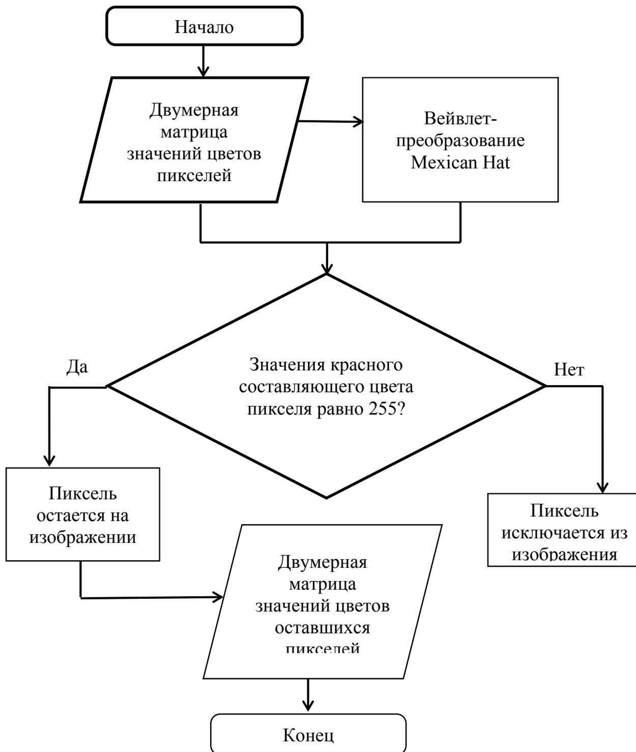
Рисунок 35 – Общая схема алгоритма сегментации микроскопического изображения мокроты, окрашенной по методу Циля-Нильсена с использованием вейвлет-преобразования Mexican Hat
