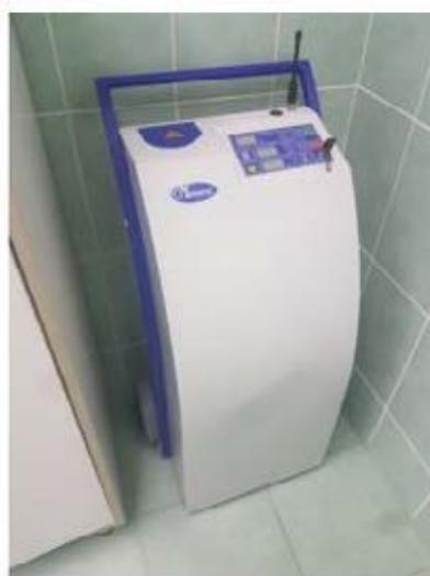
**Рисунок 12** – Импульсный лучевой аппарат для обработки операционной при работе с ГКВИ
