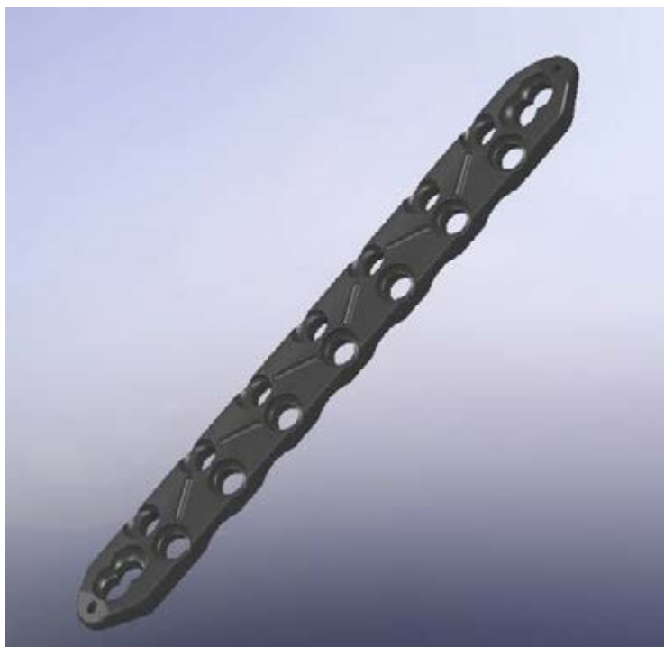
Рисунок 2.3 — Биомеханическая модель оригинальной двухрядной пластины, построенная методом конечных элементов
