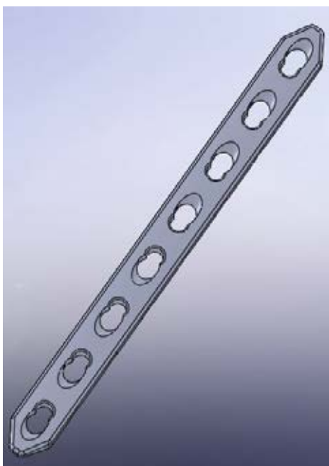
Рисунок 2.6 — Модель традиционной накостной пластины с угловой стабильностью винтов
