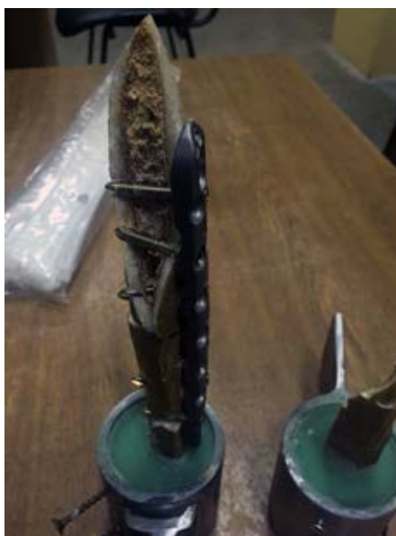
Рисунок 3.2 — Испытание на кручение: модель кости и пластины в предельном состоянии
