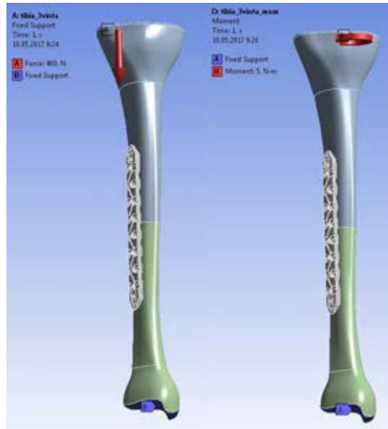
Рисунок 3.10 — Граничные условия: синим показана область жесткой заделки, красным — область приложения силы и момента
