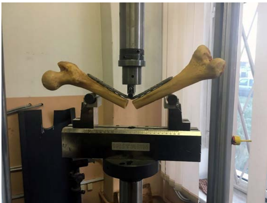
Рисунок 3.1 — Испытание на трехточечный изгиб: модель кости и пластины в предельном состоянии
