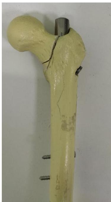
**Рисунок 32** – Модель перелома шейки бедренной кости в условиях остеосинтеза цефаломедулярным фиксатором гамма-гвоздь
