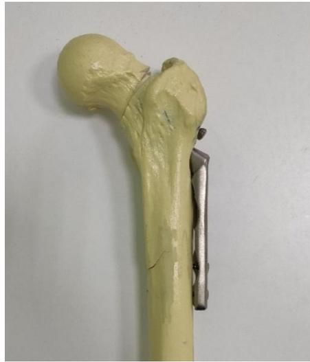
**Рисунок 26** – Модель перелома шейки бедра в условиях остеосинтеза динамическим бедренным винтом
