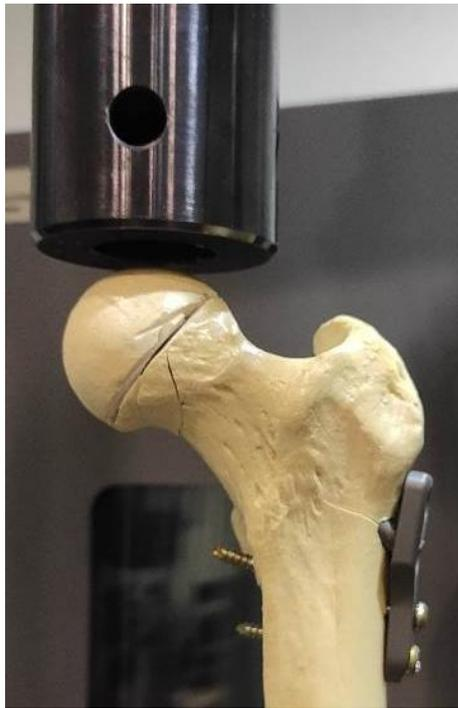
**Рисунок 38** – Фиксация модели бедренной кости в условиях остеосинтеза шейки бедра телескопическими винтами с угловой стабильностью в захвате испытательной машины MTS 870 Landmark
