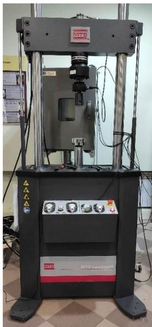
**Рисунок 37** – Многофункциональная сервогидравлическая испытательная машина MTS 870 Landmark
