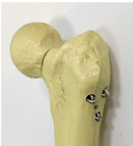
**Рисунок 20** – Модель перелома шейки бедренной кости в условиях политензофасцикулярного остеосинтеза
