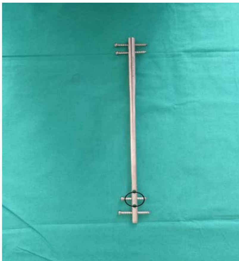
Рисунок 18 – Поломка интрамедуллярного штифта II типа. Уровень поломки обведен черным цветом
