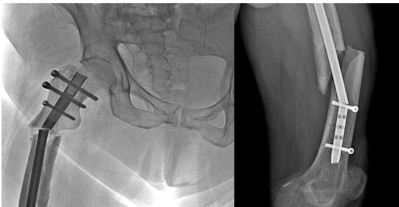
Рисунок 12 –Поломка интрамедуллярного штифта: слева – I типа, справа – II типа
