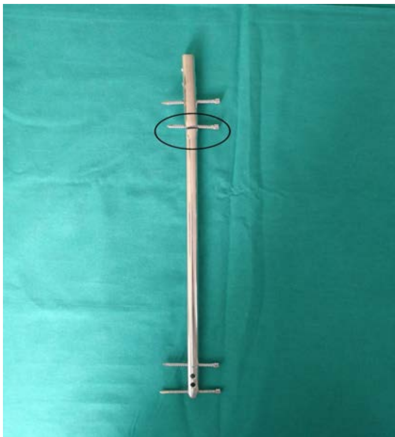
Рисунок 14 – Поломка интрамедуллярного штифта I типа. Уровень поломки обведен черным цветом
