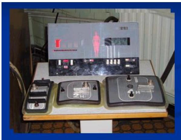
Рис. 1. Аппарат для СВЧ-гипертермии «Яхта-4» с аппликаторами
