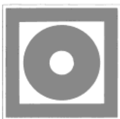
Кнопка включения установок (систем) пожарной автоматики
